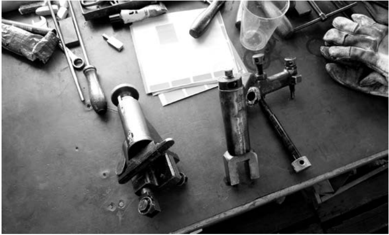
Gietkop van de Stempel-machine gedemonteerd
