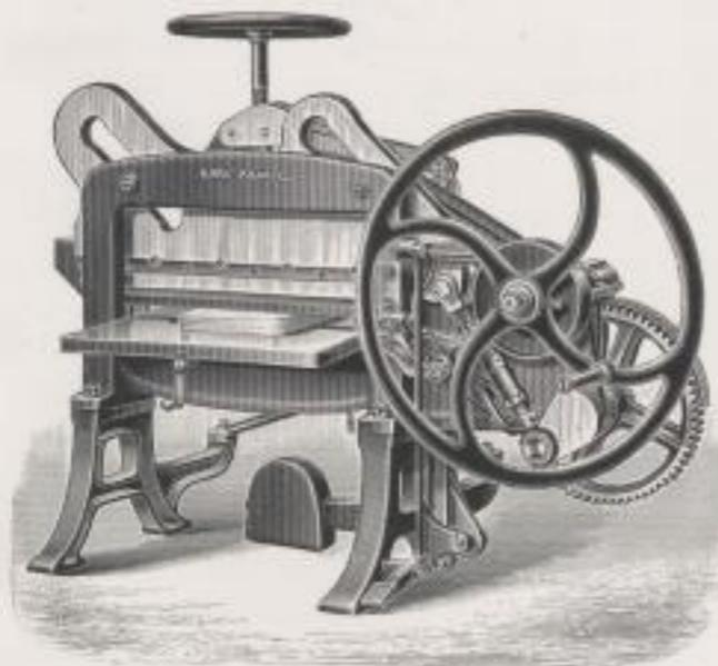
Papier-schneidemaschine, älteste Konstruktion.
