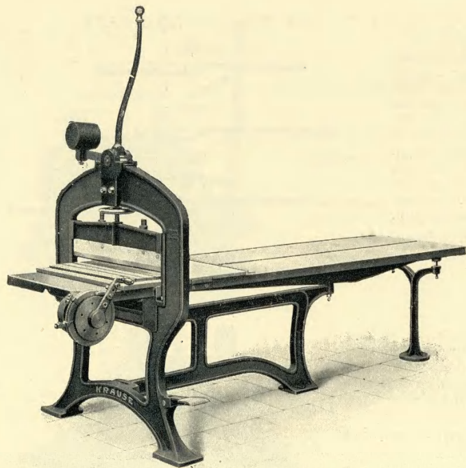
Modell ANbz3c mit dreifacher Hintertischlänge und Handhebel-Doppelvorschub.
