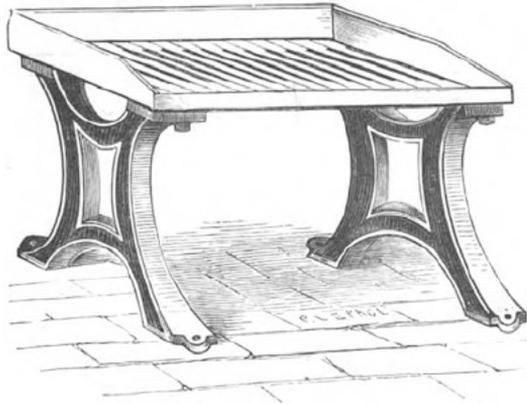
Pour répondre à de nombreuses demandes, j'ai exécuté un nouveau modèle d'auge en fonte montée sur pied en fonte, d'un facile aménagement, qui fera partout disparaître ces lourdes et incommodes pierres creuses. Le fond est garni de barres en bois d'un remplacement peu coûteux, destinées à favoriser l'écoulement du liquide et à
