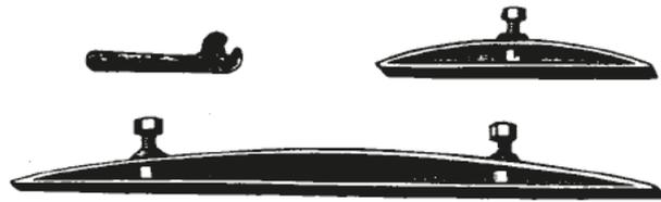
Indépendamment des coins et biseaux, je fabrique en grand un autre système de serrage. Ici, plus de marteau ni de décognoir, une simple clef suffit pour le serrage et le desserrage. Ce système convient plus spécialement aux châssis de précision pour les tirages en couleurs.
