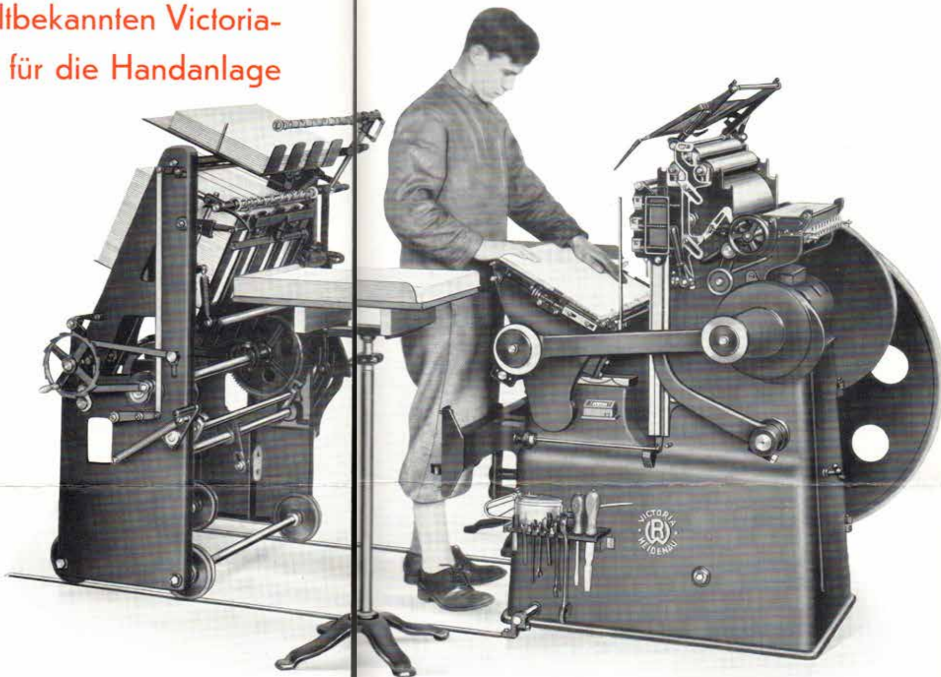
So bequem ist das Zurichten und Anlegen bei abgefahretem Bogenan- und -ablegeapparat
