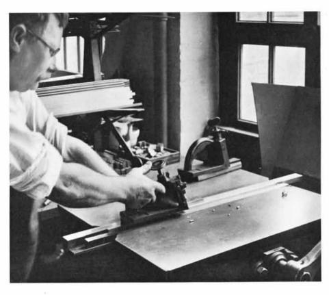
Die auf der Handgießmaschine gegossenen Schriften sind noch nicht gebrauchsfertig, sondern müssen vom Fertigmacher weiter bearbeitet werden. Die Buchstaben besitzen, wie die im alten Handgießinstrument gegossenen Lettern, einen Angußzapfen und Grate an den Kanten des Kegels. Der Anguß wird mit der Hand abgebrochen, bei größeren Graden mit dem Hammer abgeschlagen, während der Grat
