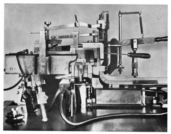
Komplettgießmaschine mit geöffnetem Gießinstrument. Die Matrize und der Weg des gegossenen Buchstabens W sind sichtbar.
