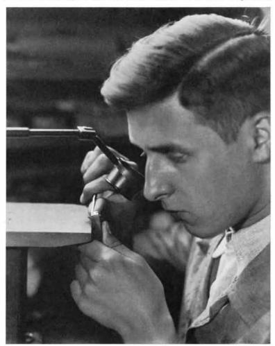
Schneiden des Stahlstempels mit der Hand
