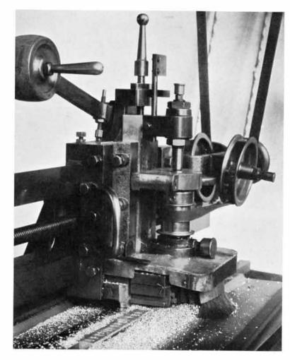
Höhenfräsmaschine in der die Schrift auf die gewünschte Höhe abgefräst wird
