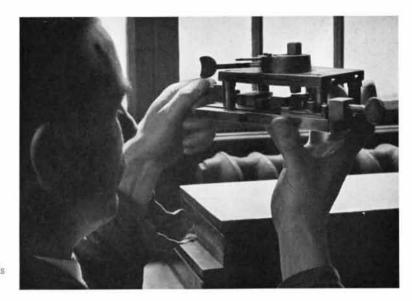
Einpassen des Stahlstempels in das Richtinstrument
