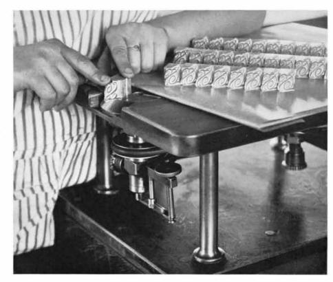
durch Schleifen auf einem rauhen Stein und durch Abschaben mit der Ziehklinge (Schabeisen) entfernt wird. Schließlich muß noch der Fuß der Buchstaben in einem Bestoßzeug glattgehobelt werden.
